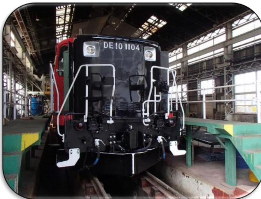
【全般検査中のDE10型機関車】
